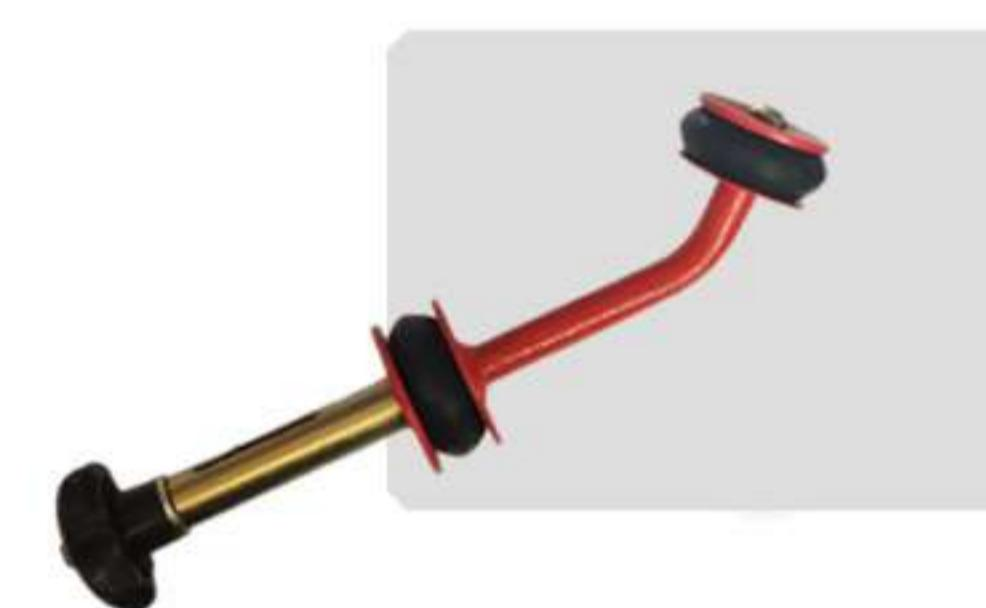
◆ کاربرد: جداسازی و ایزوله کردن یک بخش از سیستم جهت انجام تست آب بند
