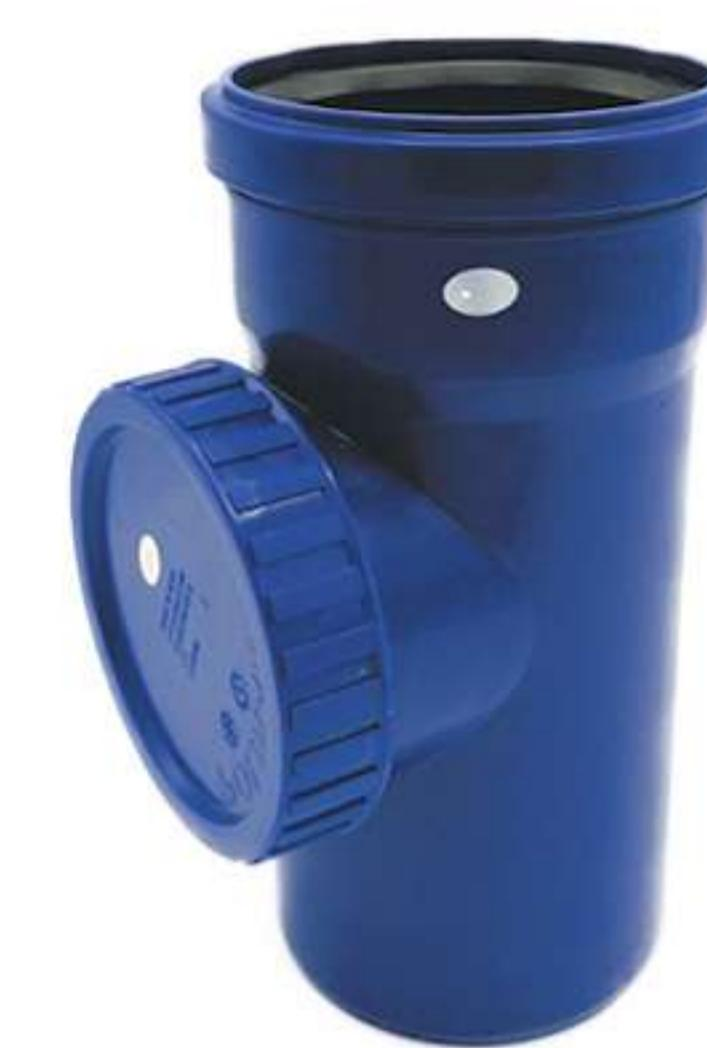
برای اطمینان از نبود هرگونه نشتی و اشکال در عملکرد سیستم فاضلاب لازم است تمامی قسمت‌های این سیستم به وسیله فشار آب و با کمک سه راه بازدید آزمایش گردد. براساس مبحث شانزدهم مقررات ملی ساختمان انجام تست در هر بخش از سیستم فاضلاب باید با حداقل فشار سه متر ستون آب انجام پذیرد، با این
