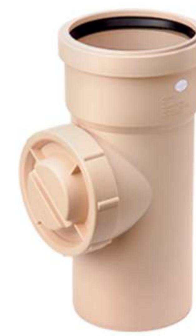
برای اطمینان از نبود هرگونه نشتی و اشکال در عملکرد سیستم فاضلاب لازم است تمامی قسمت‌های این سیستم به وسیله فشار آب و با کمک سه راه بازدید آزمایش گردد. براساس مبحث شانزدهم مقررات ملی ساختمان انجام تست در هر بخش از سیستم فاضلاب باید با حداقل فشار سه متر ستون آب انجام پذیرد، با این
