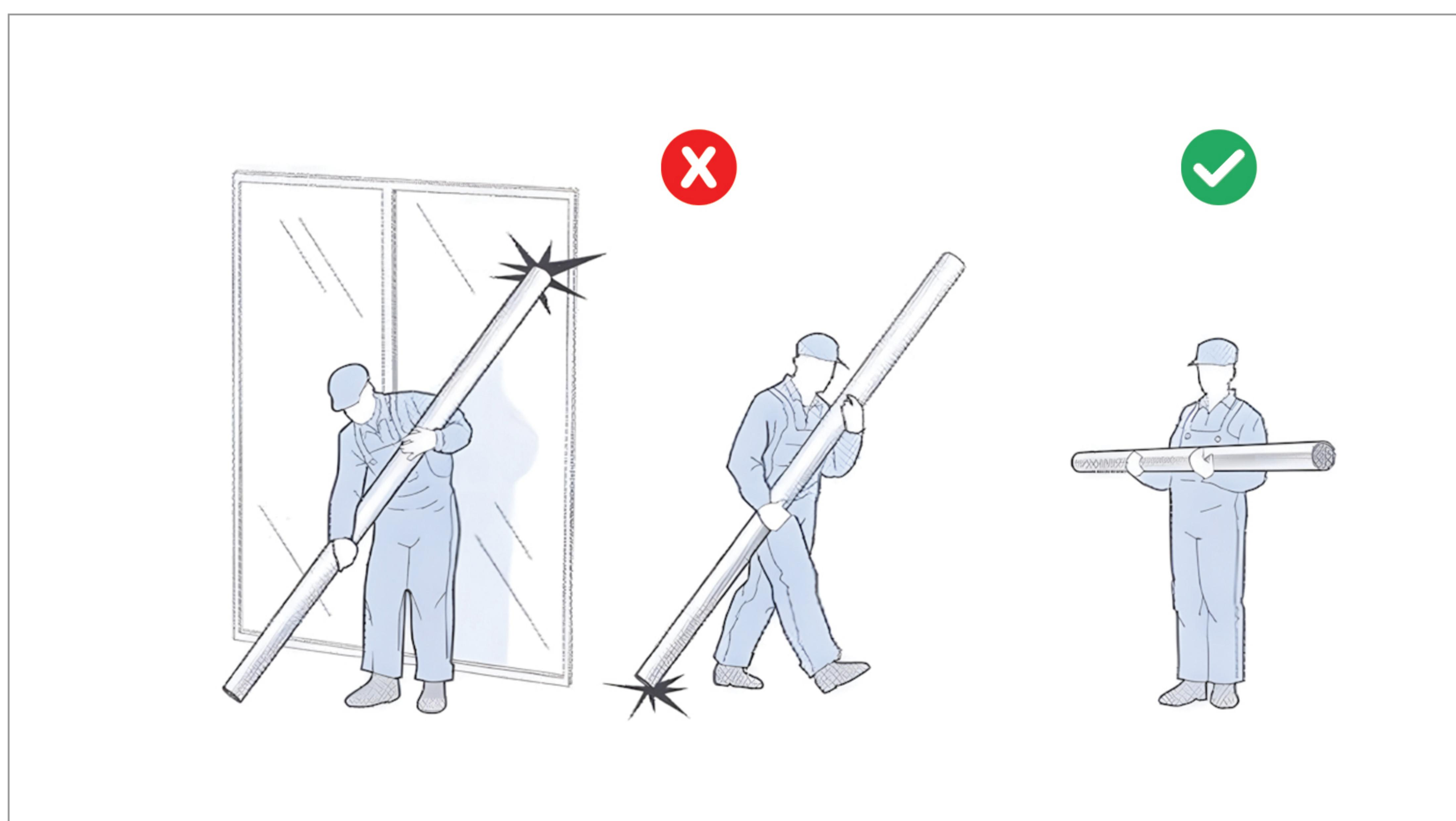
. از انداختن و پرت کردن لوله و اتصالات در هنگام بارگیری یا تخلیه خودداری شود.
