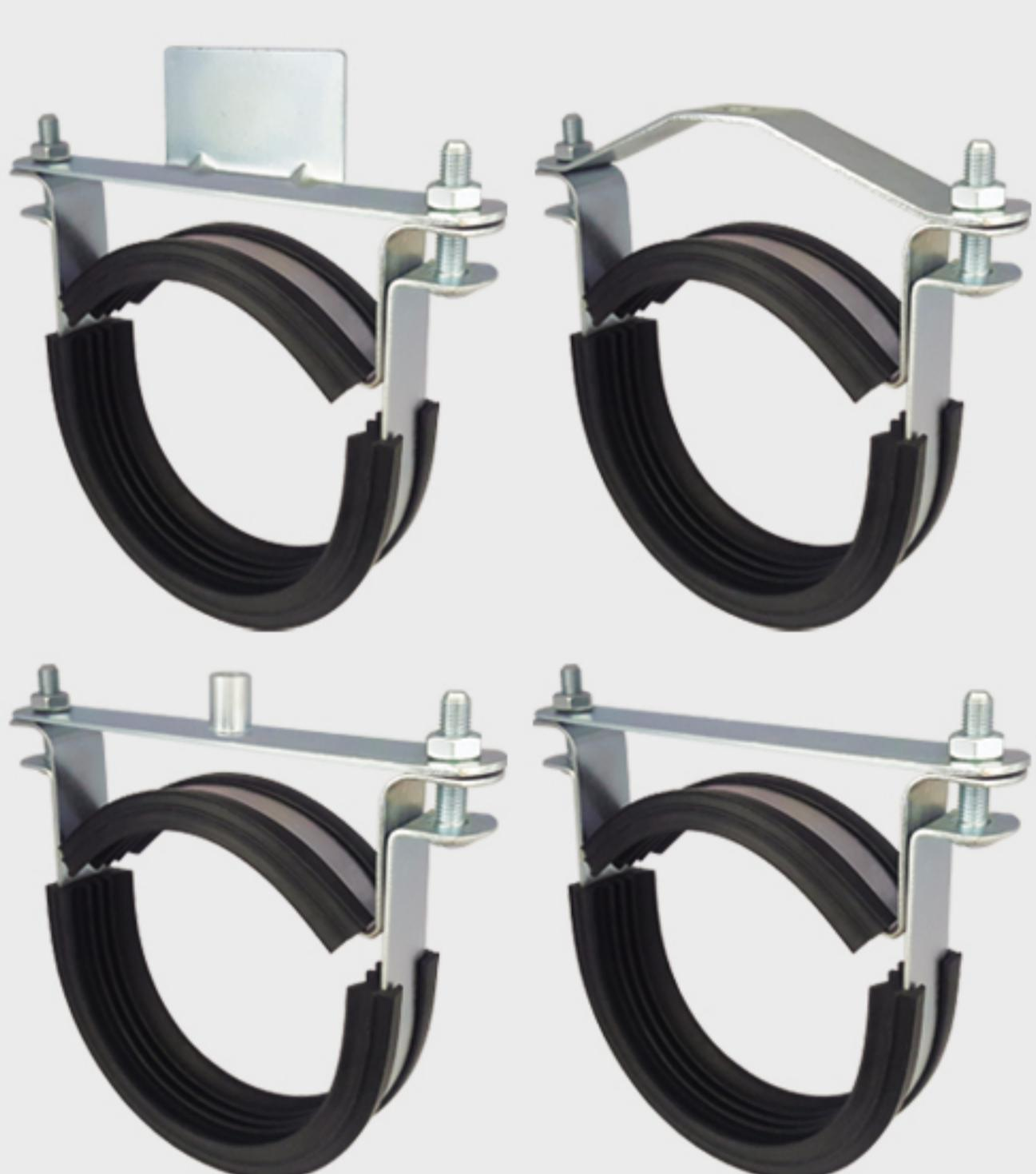
این بست با طراحی ویژه برای سیستم‌های فاضلاب ساختمانی کاهنده انتقال صدا با استفاده از لاستیک ویژه به کار رفته در آن مانع از انتقال ارتعاشات ناشی از عبور جریان به سازه و محیط داخلی ساختمان می‌گردد. عملکرد فوق العاده این بست در کاهش انتقال صدا توسط موسسه معترض فرانهوفر آلمان مورد آزمایش قرار گرفته و تأیید شده است.
